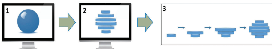
Slika 2. Šematski prikaz procesnog lanca aditivnih tehnologija (1. 3D CAD Model; 2. CAD Model u softveru – slicer; 3. Dodavanje i taloženje sloj po sloj)
