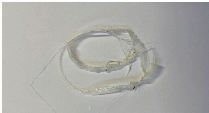
Slika 11. Opiljak – greška u pripremi parametara za štampanje i loše kalibracije 3D štampača
