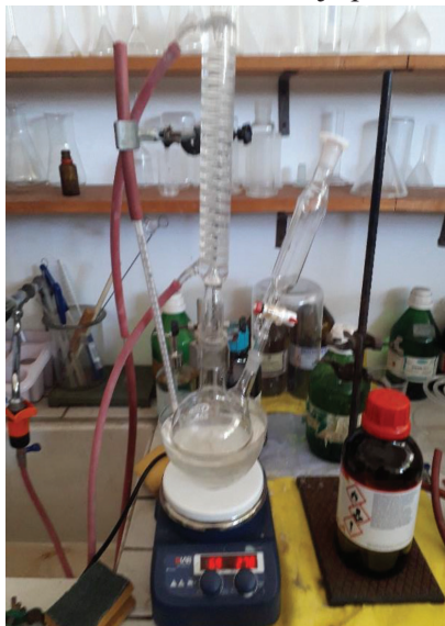
Slika 1. Aparatura za sintezu tiokarbohidrazida
