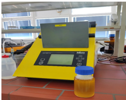
Slika 3. Turbidimetar marke Haffmans (Laboratorija za kontrolu kvaliteta, Pivara „Trebjesa“)
