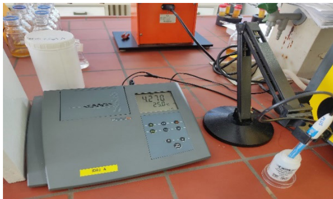
Slika 6. pH mjeter sa elektrodom i rastvorom KCL-a (Laboratorija za kontrolu kvaliteta, Pivara „Trebjesa“)
