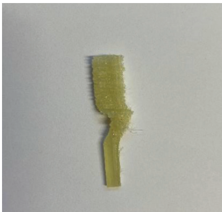
Slika 15. Gornja polovina epruvete sa greškom
