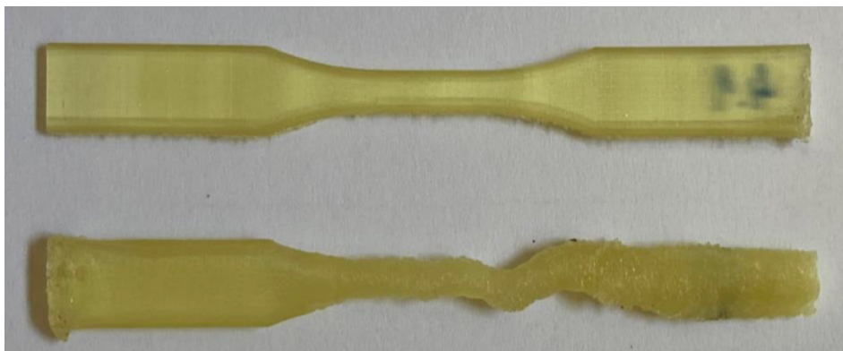
Slika 17. Poređenje dobre i loše epruvete
