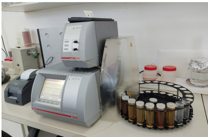
Slika 7. Anton Paar Alcoolyzer Plus (Laboratorija za ispitavanje kvaliteta, Pivara „Trebjesa“)
