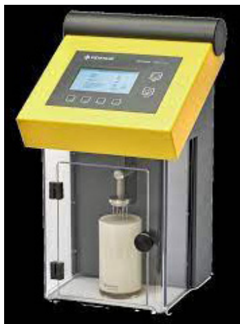
Slika 5. NIBEM uređaj za mjerenje stabilnosti pjene piva
