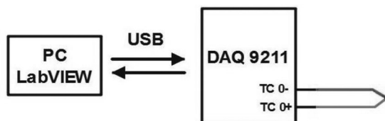
Slika 11: Vezivanje termopara sa akvizicionom karticom
